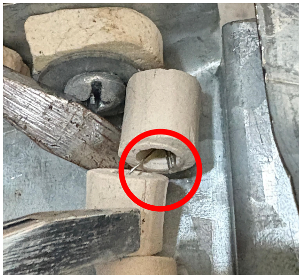
Figura 3: Filamento de Resistencia Roto
