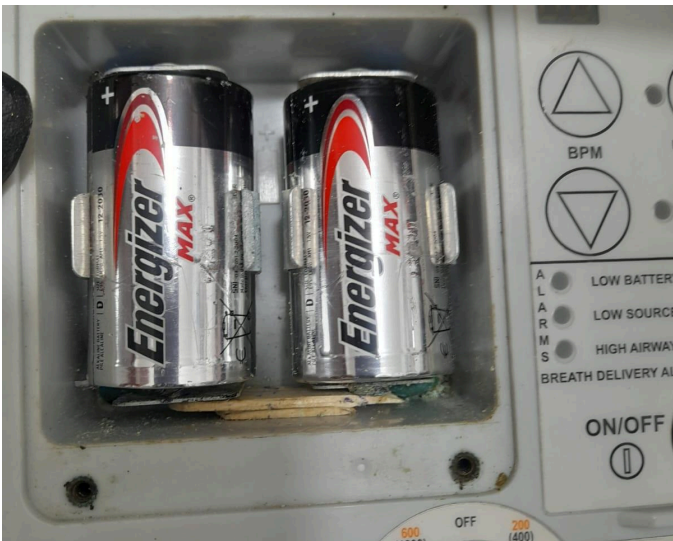
Figura 2. Placa de contacto de baterías antes de mantenimiento.
