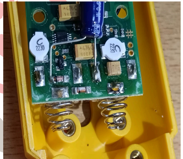
Fig. 3 Óxido en circuitos y corrosión
