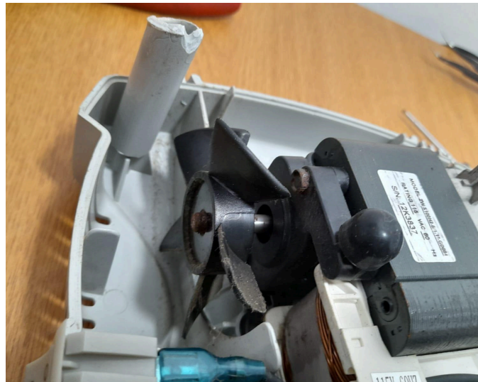
Figura 5. Hélice desviada.
