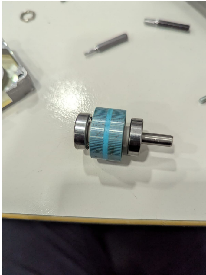
Fig 3. Rotor del motor “paso a paso” en buenas condiciones
