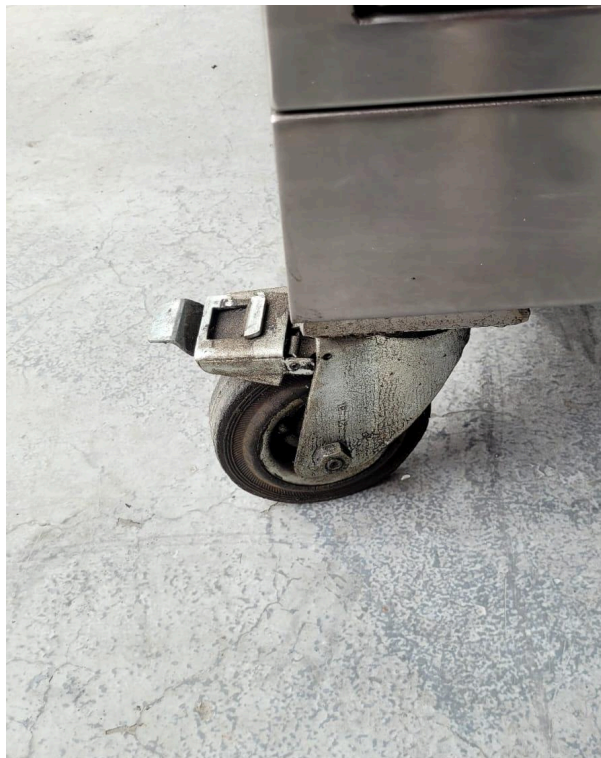
Fotografía 6. Revisión de daño en frenos del equipo.
