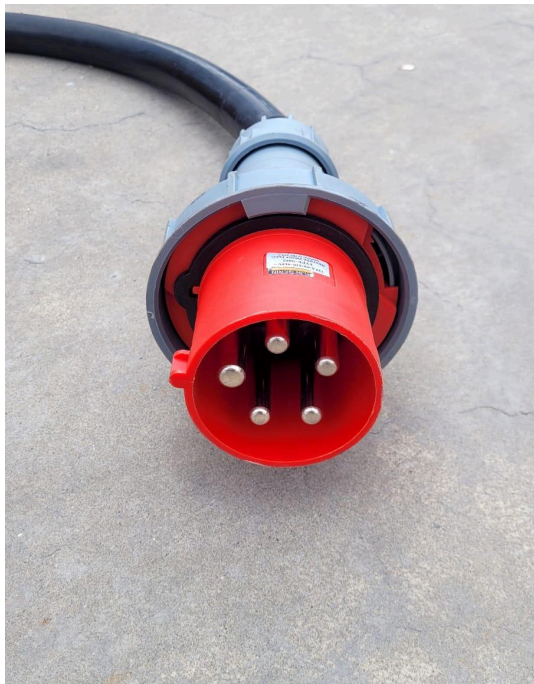
Fotografía 4. Inspección de los pines del cable de alimentación eléctrica del equipo.
