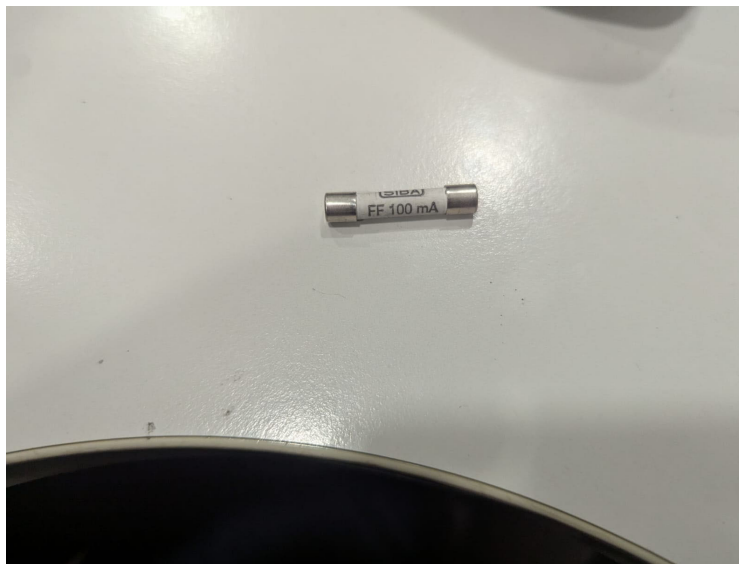
Fig 2. Fusible defectuoso (abierto)
