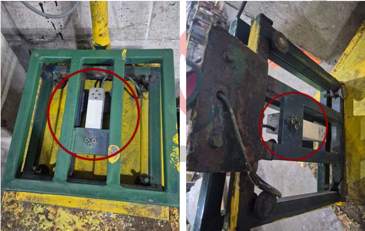
Limpieza y ajuste de celda de carga.
