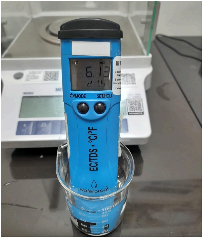
Figura 2. Lectura incorrecta en solución patrón de 12.88 µS/cm.
