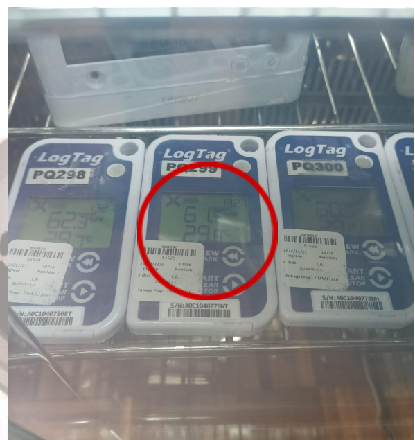
Figura 4: Error en punto 50%HR equipo 51625-PQ299.
