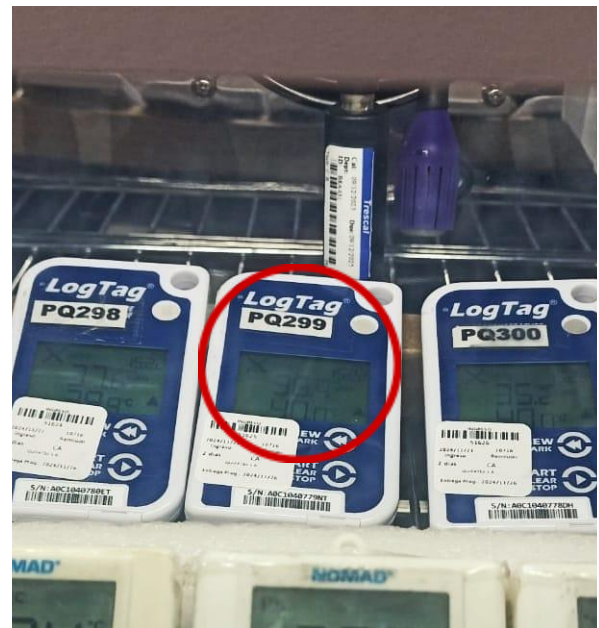
Figura 2: Error en punto 30%HR equipo 51625-PQ299.
