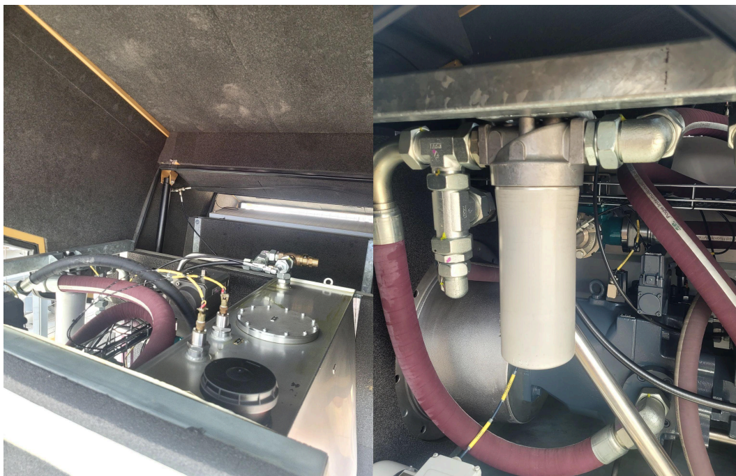
Fotografía 6. Inspección de fugas de aceite en el interior del equipo.
