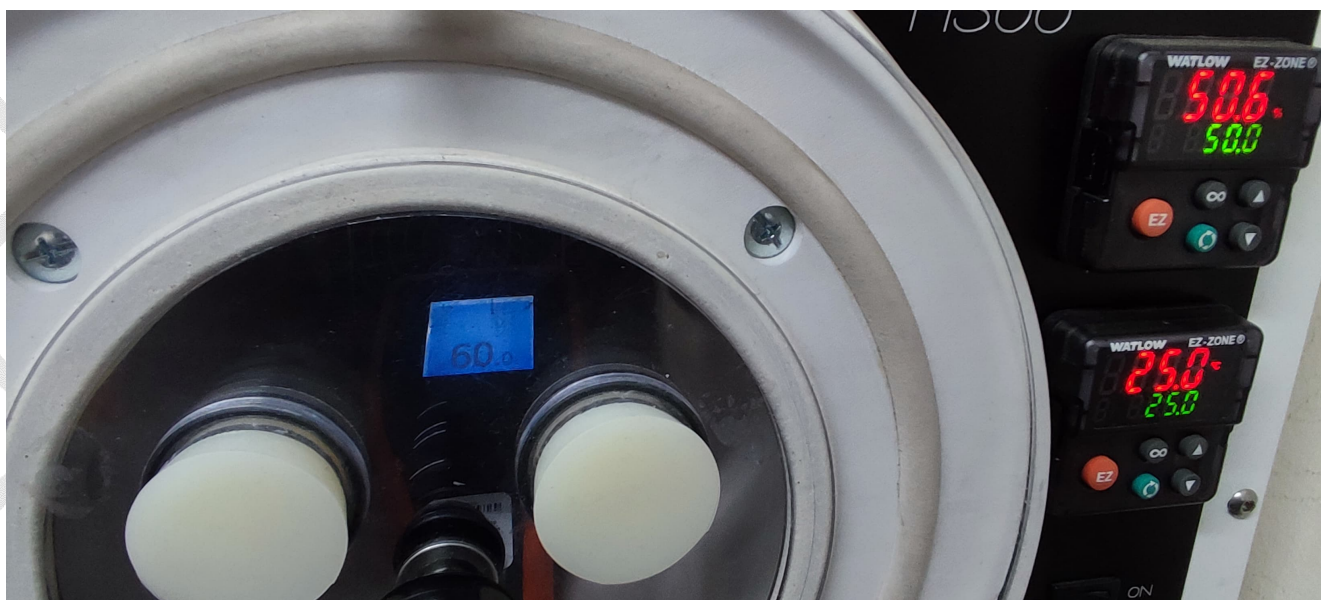
Imagen de pruebas en la cámara climática. El error es de +9.4 %HR
