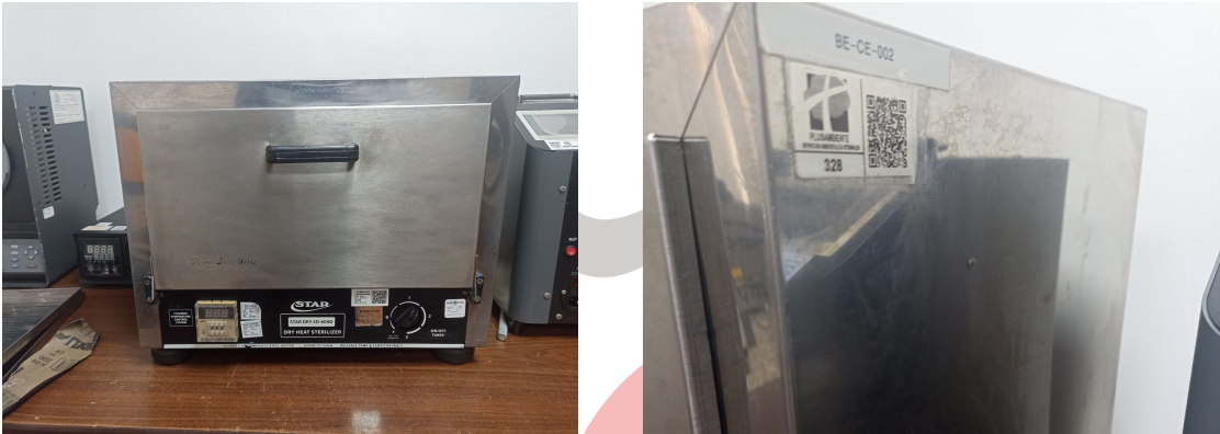
Fig. 3 Vista Libre de Corrosión Externa
