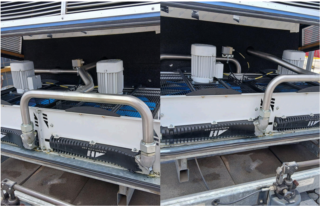
Fotografía 7. Inspección y limpieza de mangueras.
