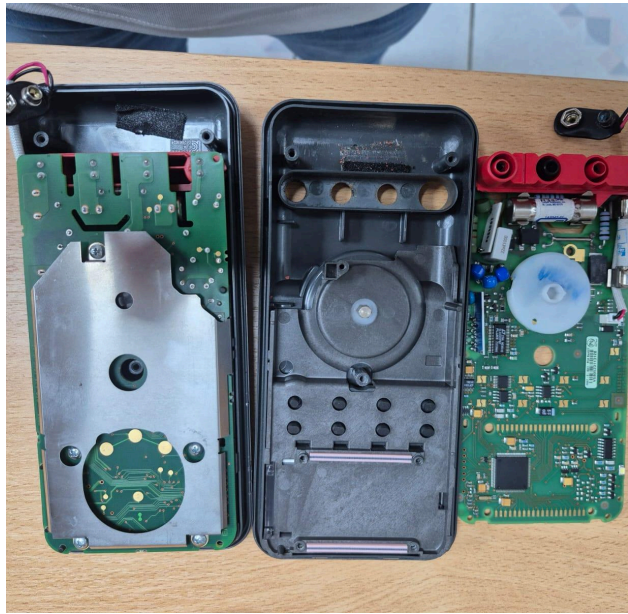
Figura 2. Vista de las placas electrónicas de los multímetros.
