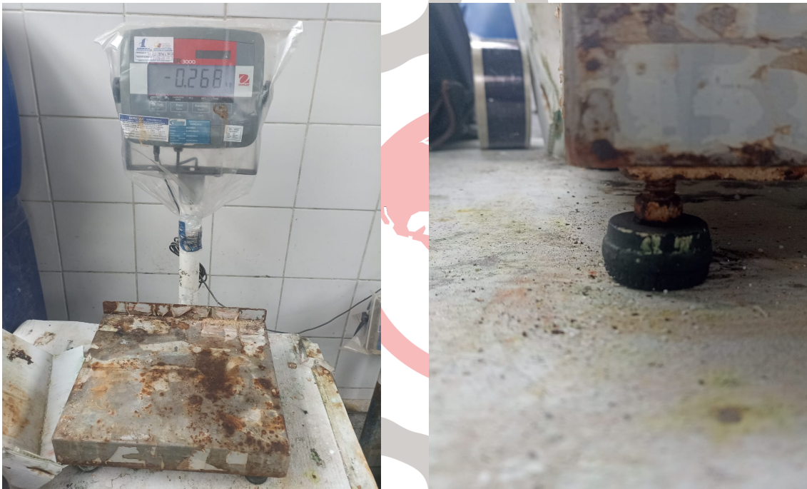
Figura 2. Exceso de Corrosión.
