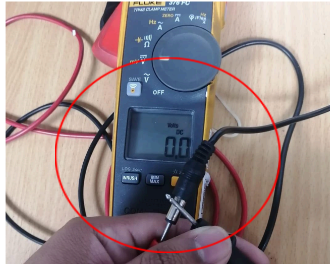
Figura 2: Salida de voltaje del adaptador.
