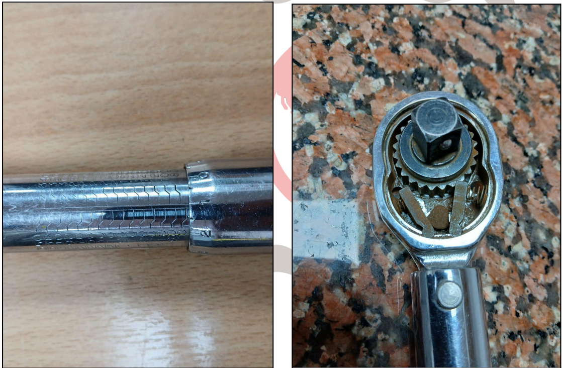
Fig. 2 Dial de medición y resorte
