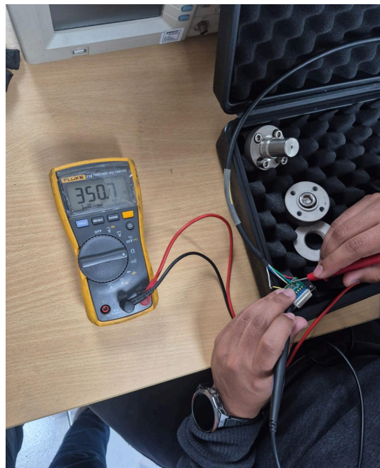
Figura 4. Valor de resistencia de salida de la celda.
