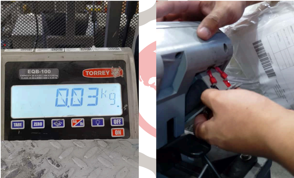
Figura 2. Cambio de batería y encendido del equipo.
