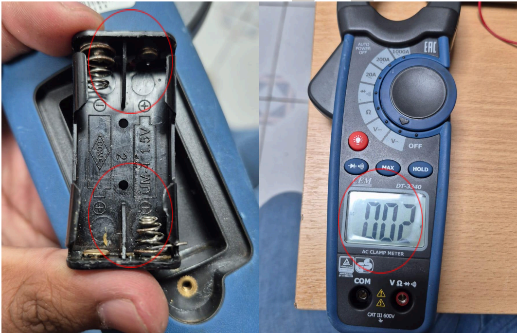
Figura 2. Bornes arreglados y el estado de la placa del dispositivo indicador..
