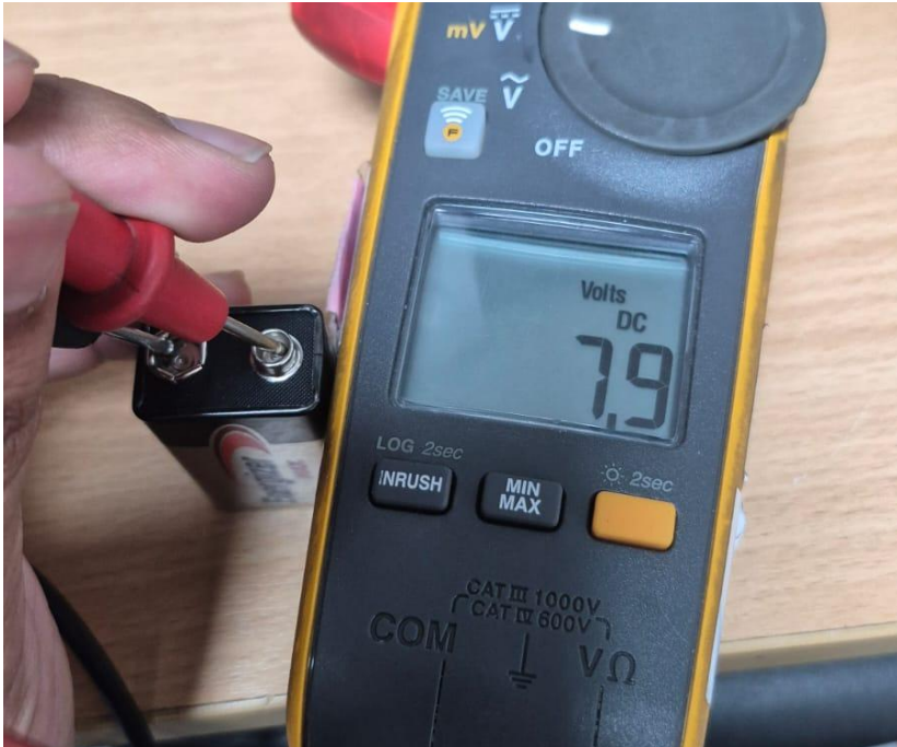
Figura 1. Estado de la batería.
