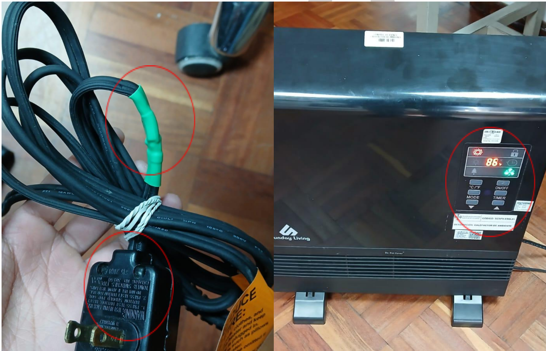
Figura 2. Nuevo conector arreglado y encendido del equipo.
