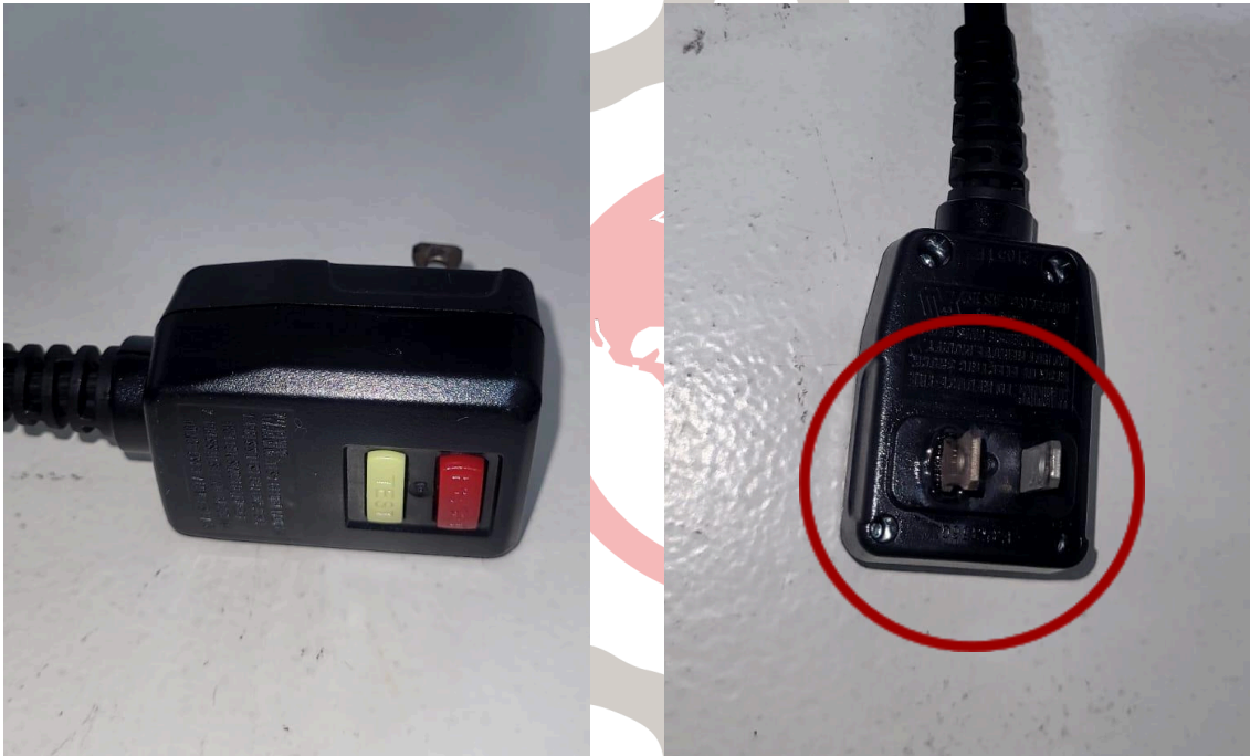
Figura 2. Protección GFCI quemado.
