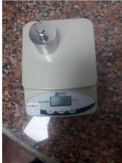
Figura 3: Afectación en el pesaje - Exentricidad
