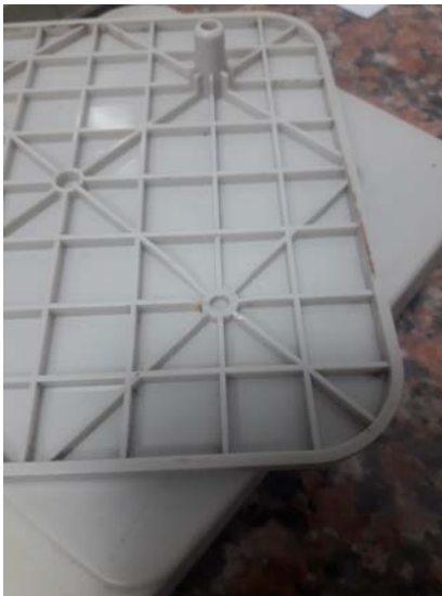
Figura 1: Soporte roto de Bandeja
