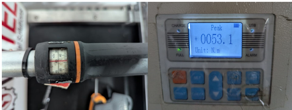
Fig 1 Torquímetro seteado a 60Nm, medidor de fuerza muestra 53.1Nm, lo cual representa un error de 12%, cuando el mínimo aceptado es de 4%
