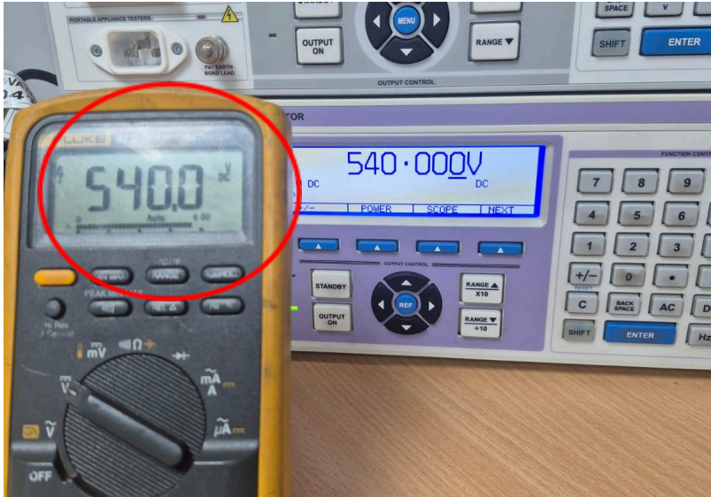
Figura 4. Verificación de valores del multímetro.
