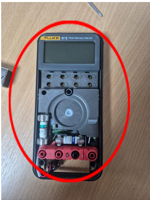
Figura 3. Cambio de placa electrónica del multímetro.
