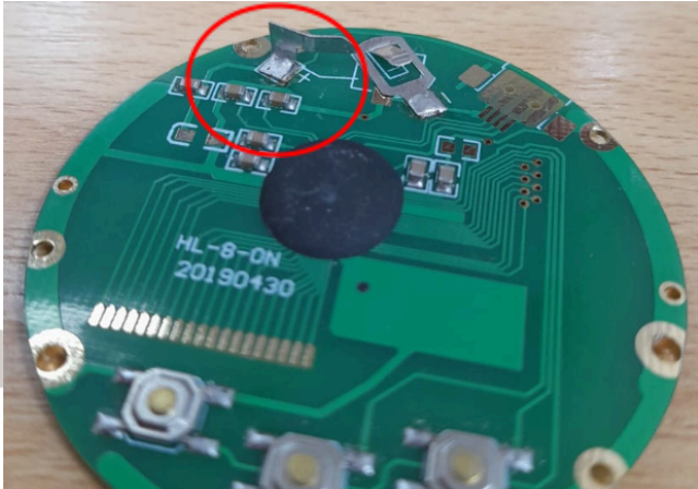
Fig. 4 Resoldadura de porta batería
