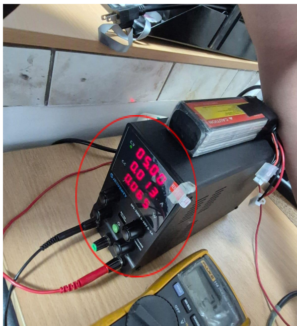
Figura 1. Valor de energización para la celda.
