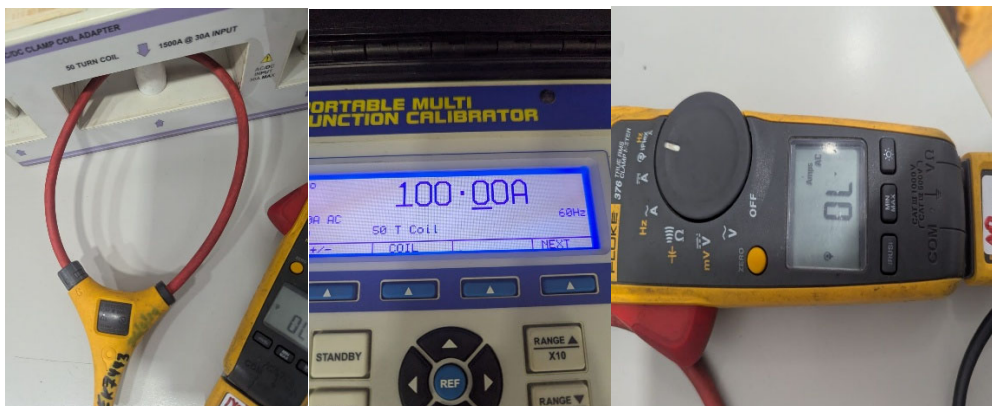
Fig 1 Prueba del equipo @100 A, no se registró el valor esperado
