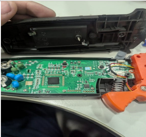
Imagen 1.0 Revisión de terminales de batería.
