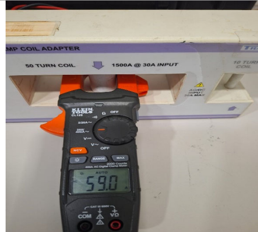
Imagen 4.0 E Pruebas de corriente a 60 Aac
