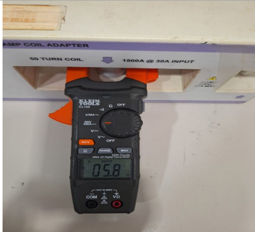
Imagen 3.0 Pruebas de corriente a 6 Aac
