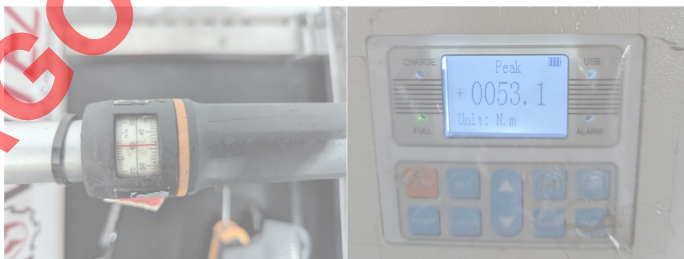
Fig 1 Torquímetro seteado a 60Nm, medidor de fuerza muestra 53.1Nm, lo cual representa un error de 12%, cuando el mínimo aceptado es de 4%
