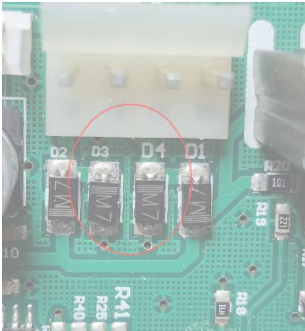
Figura 1: Diodos dañados.
