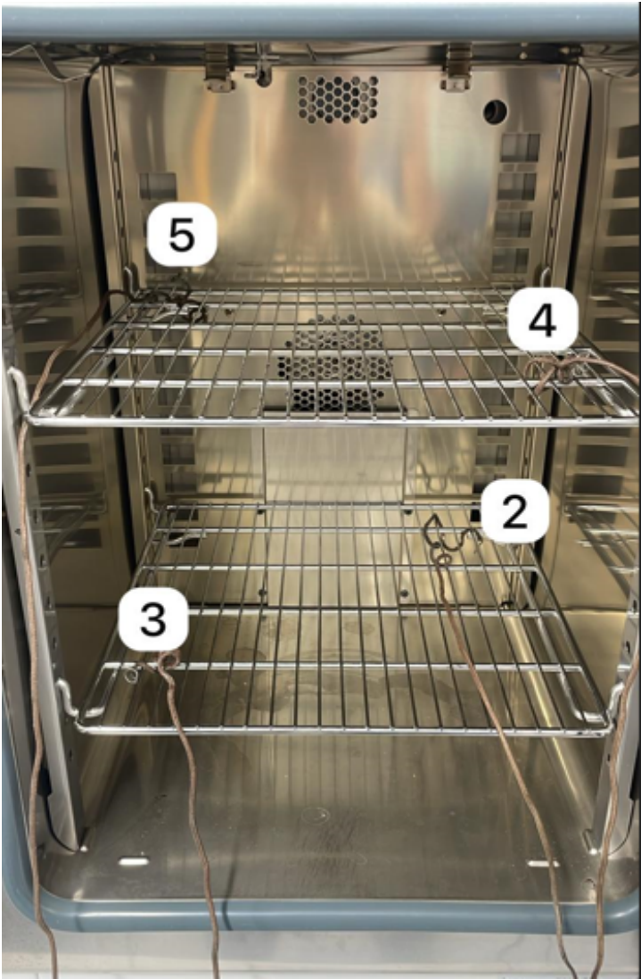
Disposición de sensores en la zona de trabajo durante la prueba
