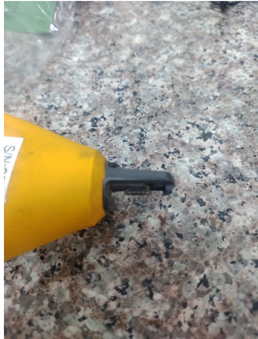
Plástico que recubre los sensores se encuentra roto
