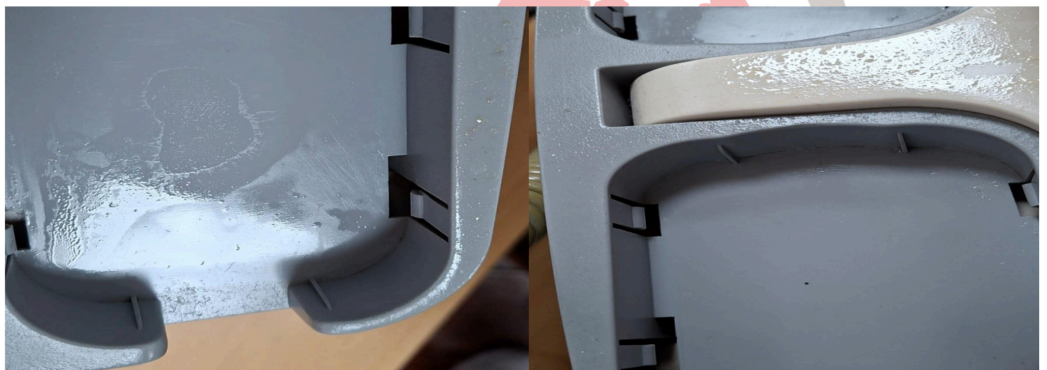
Figura 2. Presencia de aceite en equipo
