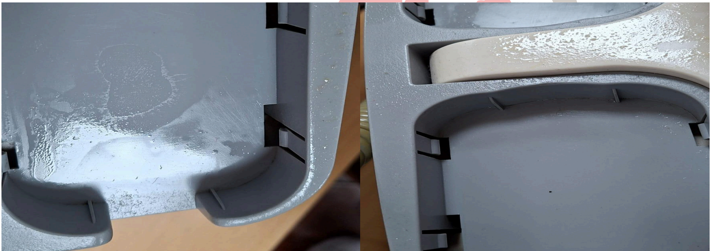
Figura 2. Presencia de aceite en equipo
