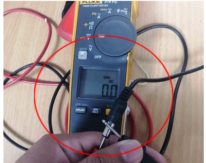
Figura 2: Salida de voltaje del adaptador.
