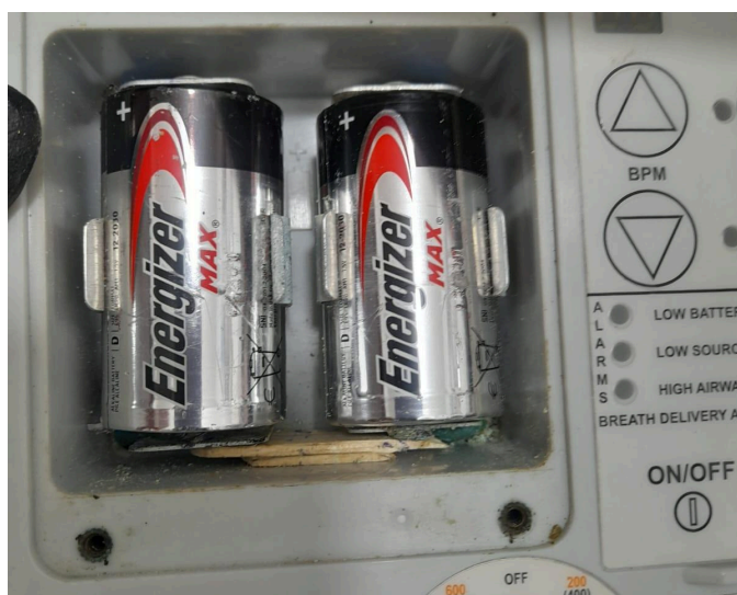
Figura 2. Placa de contacto de baterías antes de mantenimiento.
