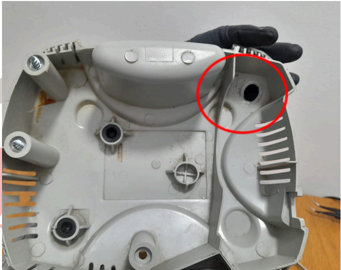
Figura 3. Piezas rotas de carcasa.
