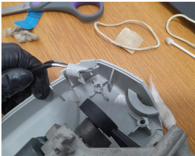
Figura 4. Piezas rotas de carcasa.
