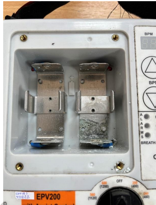
Figura 2. Señales de Sulfatación en los bornes de la batería.
