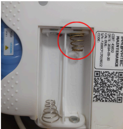
Figura 2. Zona con presencia de óxido
