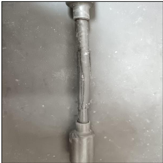
Fig. 8 Acción correctiva (Termoencogible)
