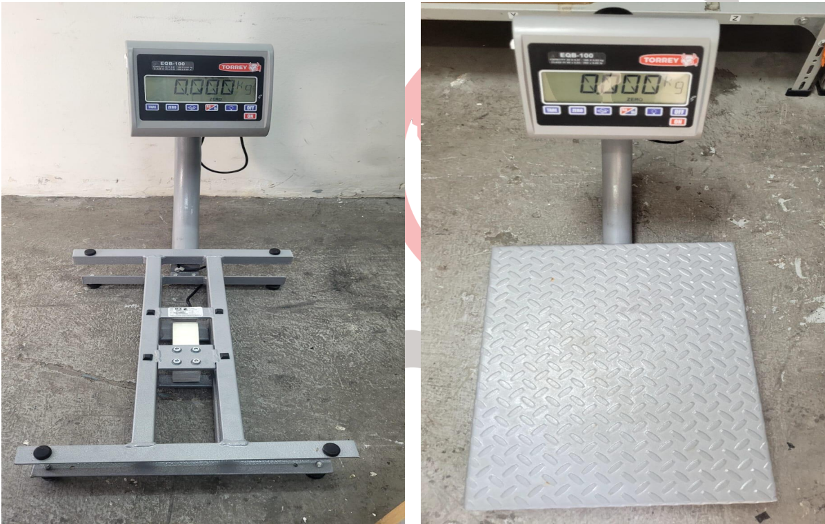
Limpieza y ajuste de celda de carga.
