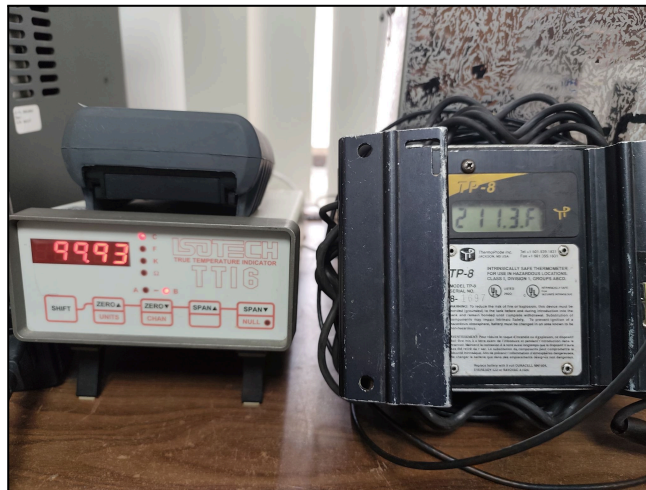
Fig. 1 Comparación de lectura de temperatura: Patrón vs. Equipo
