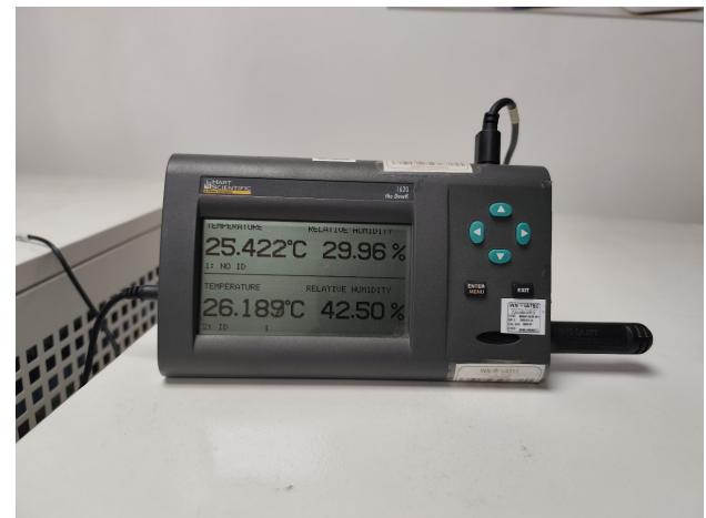
Equipo dentro de la cámara climática, el sensor patrón marca 29.96 HR%, mientras que el equipo registra 39.0 HR%, teniendo un error de + 9.04 HR%.
