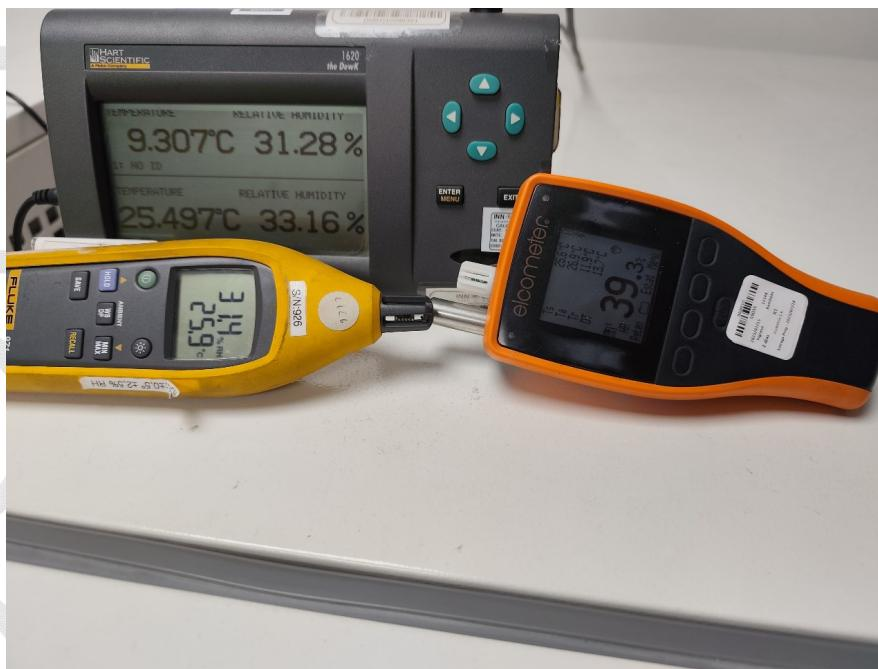
Prueba climática externa, en comparación con el sensor patrón y un equipo en correcto funcionamiento. La humedad presente en el ambiente es de 31.28 HR%, el equipo registra 39.3 HR%, el error es de +8.2 %HR
