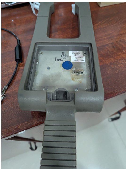
Fig 2. Placa con elemento medidor defectuoso
