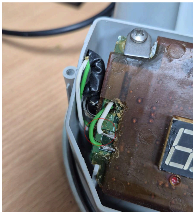
Figura 2: Sección donde el pin de carga se encuentra conectado con la placa electrónica.
