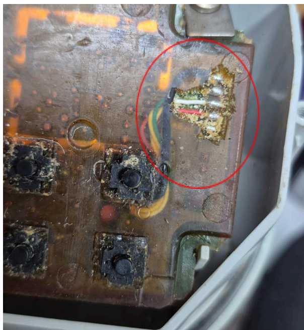
Figura 1: Conexión de la celda de carga con la placa electrónica.
