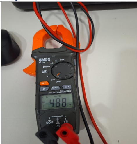
Imagen 5.0 Pruebas de tensión a 480 Vac
