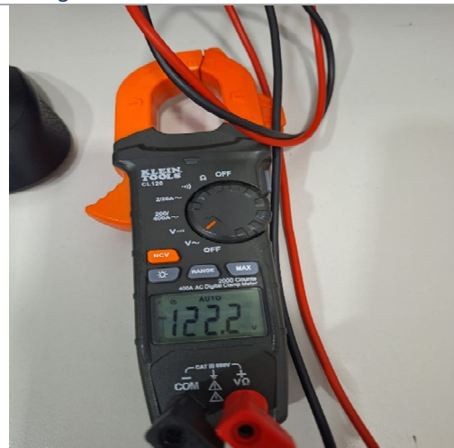
Imagen 6.0 Prueba de tensión a 120 Vac
